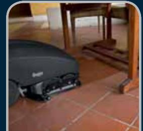
Genie Bs peut également nettoyer sous les étagères ou les éléments se trouvant à 38 cm du sol grâce au design du réservoir solution au barycentre très bas
