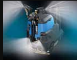
Le kit Disinfektor se compose de deux groupes de buses positionnées au-dessus du réservoir pour désinfecter les surfaces verticales et d'un groupe à la base de la machine destiné au sol
