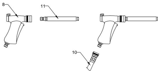
Raccorder le pistolet (rep.8) sur le raccord de la lance (rep.11)
