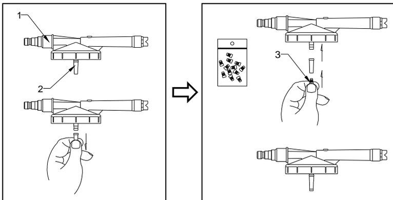
Insérer l'embout droit noir (rep.2) sur couvercle de l'Evofaster (rep.1) si celui-ci n'est pas encore positionné.
