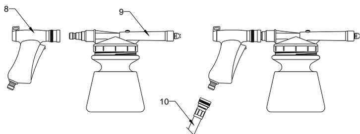
Raccorder le pistolet (rep.8) sur le raccord du Bol Evofaster (rep.9)
