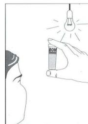
Attendre 2 minutes puis comparer la couleur obtenue à celle de l'échelle colorimétrique intégrée sur l'étiquette du tube.
