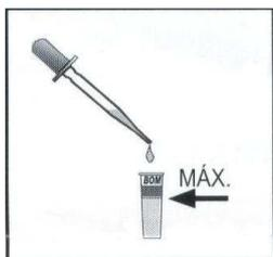
Retirer le bouchon du tube et à l'aide de la pipette introduire l'huile chaude (entre 65 et 120°C) jusqu'au niveau bas de l'étiquette.
